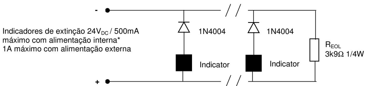
\* Usando a fonte de alimentação da central, a soma da corrente requerida pelo indicador de extinção, pelos atuadores de extinção, pela entrada de sinalizadores sonoros e pela carga ligada à saída 24V<sub>DC</sub>, não deve exceder a 950 mA.
