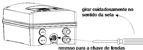
Fig. 17 Remoção do tampão do tubo de saída de ar
